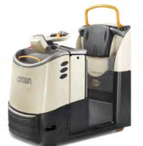
Řada TC 3000 Tahač Max. hmotnost tažené soupravy: 3000 kg
