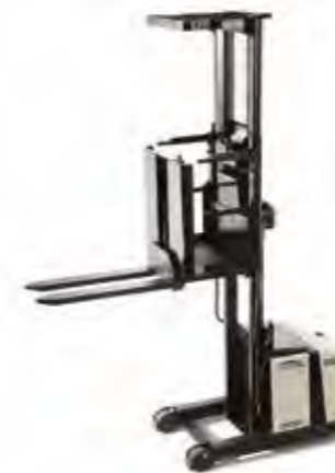
LP 3500 Serie Mittelhub-Kommissionierer Tragfähigkeit: 1000 kg Hubhöhe: 1025 bis 2440 mm
