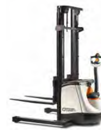
SX 3000 Serie Spreizenstapler Tragfähigkeit: 1350 kg Hubhöhe: 2400 bis 4250 mm
