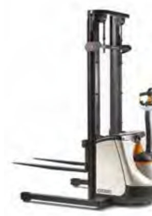
ST 3000 Serie Spreizenstapler Tragfähigkeit: 1000 kg Hubhöhe: 2400 bis 4250 mm
