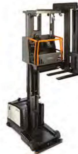
TSP 6500 Serie Hochregalstapler Tragfähigkeit: 1000, 1250 und 1500 kg Hubhöhe: 4900 bis 13485 mm
