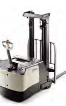
SHC 5500 Serie Hochhubwagen mit Gegengewicht Tragfähigkeit: 1100, 1350 and 1800 kg Hubhöhe: 2895 bis 4365 mm
