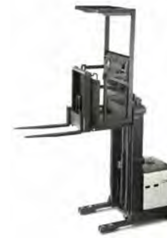
SP 3500 Serie Dreipunkt-Hochhubkommissionierer Tragfähigkeit: 1000 und 1250 kg Hubhöhe: 4215 bis 9600 mm
