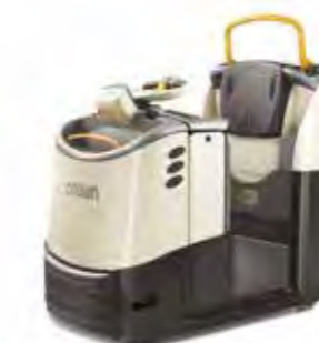
TC 3000 Serie Schlepper auch mit QuickPick® Remote Technologie erhältlich Anhängelast: 3000 kg
