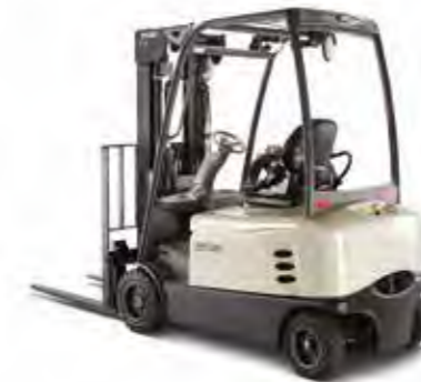
SCF 6000 Serie Vierrad-Gegengewichtstapler Tragfähigkeit: 1600, 1800 und 2000 kg Hubhöhe: 2895 bis 8075 mm
