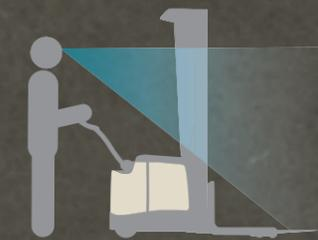
Das abgeschrägte, niedrige Profil der Antriebseinheit und der Freisichtmast sorgen beim Einfahren in und Ausfahren aus Paletten für hervorragende Sicht auf die Gabelspitzen.
