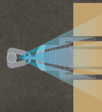
Die ausgezeichnete Sicht auf die Radarme erleichtert bei den Breitspur-Hochhubwagen die Lastaufnahme und -positionierung.
