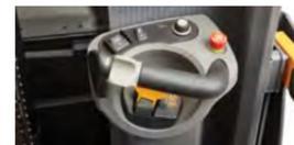
Mit der rechten Bedieneinheit kann der Fahrer mühelos die Funktionen des Staplers kombinieren und dabei vier stabile Kontaktpunkte beibehalten. Der optionale Display-Controller bietet eine weitere Möglichkeit der Bildschirmnavigation.
