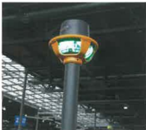
La luz verde se enciende para indicar que la carretilla está preparada para funcionar con el mando a distancia.
