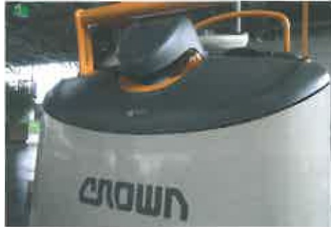
El escáner vigila atentamente los obstáculos y detiene la carretilla automáticamente en cuanto detecta alguno.
