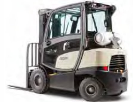
Serie C-5 Carretilla contrapesada GLP con cabina completa Capacidad de carga: 2.000, 2.500 y 3.000 kg Altura de elevación: 2.665 a 7.465 mm
