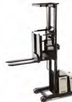
Serie LP 3500 Recogepedidos de nivel medio Capacidad de carga: 1.000 kg Altura de elevación: 1.025 a 2.440 mm
