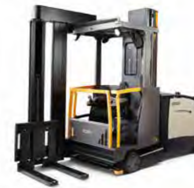
Serie TSP 7000 Recogepedidos trilateral Cap. de carga: 1.000, 1.250 y 1.500 kg Altura de elevación: 4.900 a 17.145 mm
