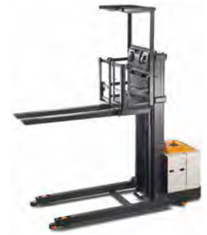
Serie SP 3500 Recogepedidos de 4 puntos de apoyo Capacidad de carga: 625 y 1.250 kg Altura de elevación: 5.335 a 9.295 mm
