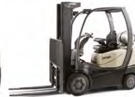
Serie C-5 Carretilla contrapesada GLP con bandajes Capacidad de carga: 2.000, 2.500 y 3.000 kg Altura de elevación: 2.665 a 7.465 mm
