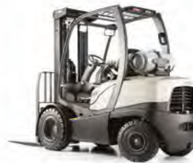
Serie C-5 Carretilla contrapesada GLP con ruedas superelásticas Capacidad de carga: 2.000, 2.500 y 3.000 kg Altura de elevación: 2.665 a 7.465 mm
