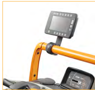
Tubo frontal de accesorios Work Assist con organización de cables
