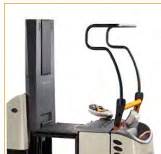
Elevación de plataforma y barrera de seguridad (GPC 3040/3060)
