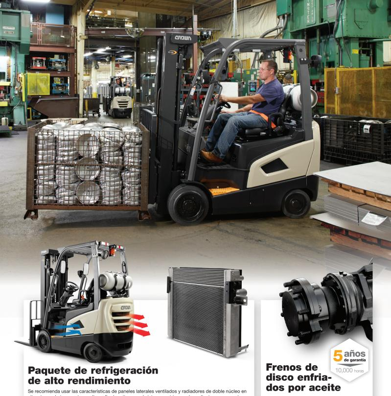
Se recomienda usar las características de paneles laterales ventilados y radiadores de doble núcleo en situaciones de temperaturas altas a fin de evitar que el sistema motriz se sobrecaliente y para mantener al operador fresco a fin de que esté más cómodo durante la jornada.
