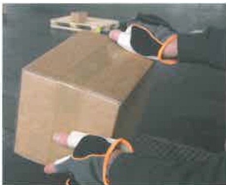
Même les mains pleines, on peut appuyer sur la touche de démarrage pour faire avancer le chariot à l'endroit exact souhaité, pour minimiser les trajets à faire à pied.
