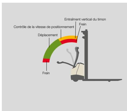
En entrant dans la zone de **neutralisation des freins avec contrôle de la vitesse**, la vitesse de déplacement dans la direction de la fourche sera automatiquement réduite à 1,5 km/h sans qu'il soit nécessaire de s'arrêter et d'obtenir un nouvel ordre du cariste.
