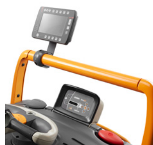
Barre avant Work Assist avec gestion des câbles
