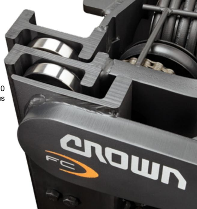
**Les mâts restent bien droits** grâce à la construction en I de Crown qui résiste aux déformations longitudinales et latérales et aux torsions.
