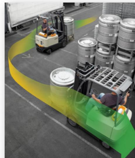
■ **Le contrôle de la vitesse de déplacement et dans les virages** limite automatiquement les vitesses de déplacement dans les virages en fonction du poids de la charge, de la hauteur de levée et de l'angle de direction.
