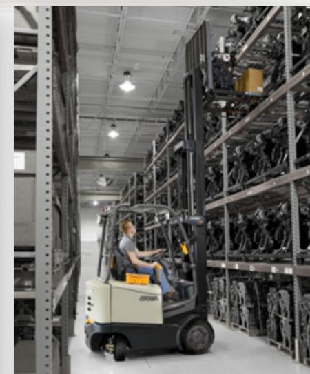
■ **Le verrouillage de l'inclinaison** réduit le risque de basculement en empêchant les fourches et le mât de s'élever au-dessus de la levée libre lorsqu'ils s'inclinent vers l'avant de plus de deux degrés.
