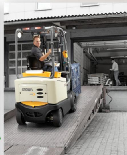
■ **Le contrôle de la vitesse sur rampe** préserve automatiquement la vitesse et le couple dans les pentes.
