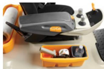
■ **Un bac de rangement magnétique** pour les petites pièces peut être installé à divers endroits du chariot. D'autres accessoires Work Assist Crown en option peuvent être posés sur les montants du toit de protection, pour un accès facile.
