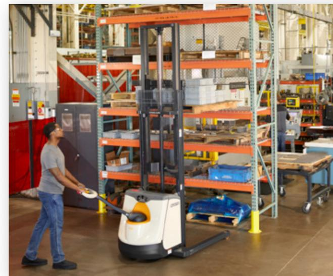
Les caristes trouvent les gerbeurs à bras encadrants faciles à utiliser pour réaliser des empilages verticaux dans des systèmes de rayonnage. La simplicité de la maniabilité simplifie le positionnement et le placement de la charge.
