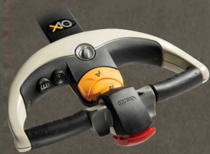
La conception flexible et ergonomique de la **poignée X10™** permet au cariste d'accéder aux commandes de chaque côté de l'ensemble de puissance, pour une visibilité optimale et une maniabilité accrue.
