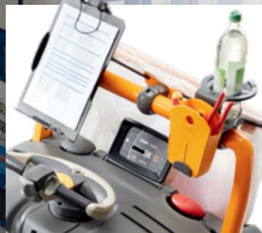
**Les accessoires Work Assist® Crown en option** peuvent être combinés et adaptés pour plus de confort et de productivité. Visible ci-dessus : porte-documents, support pour sac poubelle, poche de rangement et porte-gobelet sur le tube avant.
