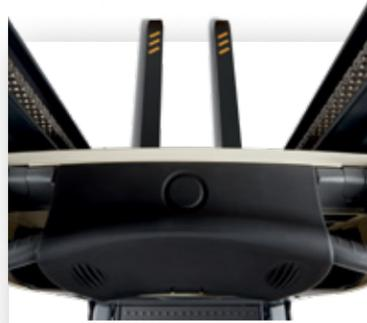
**Une visibilité optimale à travers le mât** est assurée par la construction à profilé en I imbriqué et la conception du tablier porte-fourches. De plus, la visibilité en hauteur est améliorée par la conception du toit de protection qui offre une meilleure vue lors du positionnement des fourches et des charges en hauteur.
