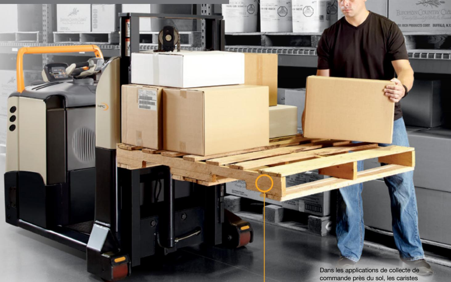
Dans les applications de collecte de commande près du sol, les caristes peuvent lever et descendre les fourches de façon à former les palettes à une hauteur confortable.
