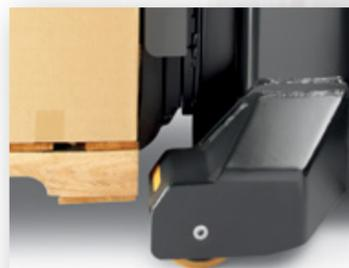
La conception à contrepoids du chariot maintient en permanence une garde complète entre les fourches et la roue porteuse, ce qui évite d'avoir à prévoir une marge supplémentaire entre les palettes et sous les convoyeurs. Les caristes peuvent gagner de la place en empilant plus étroitement les palettes et éviter des efforts inutiles en passant plus facilement sous les convoyeurs.
