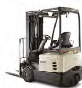
Serie SCT 6000 Carrello controbilanciato a 3 ruote Portata: 1300, 1600, 1800 e 2000 kg Altezza di sollevamento: da 2895 a 7490 mm
