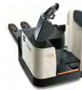
Serie PR 4500 Transpallet uomo a bordo Portata: 3000 kg
