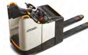
Serie WT 3000 Transpallet elettrici con pedana fissa Portata: 2000 e 2500 kg
