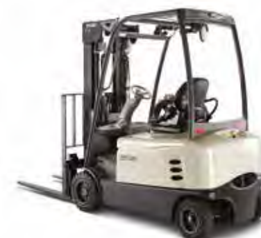
Serie SCF 6000 Carrello controbilanciato a 4 ruote Portata: 1600, 1800 e 2000 kg Altezza di sollevamento: da 2895 a 8075 mm
