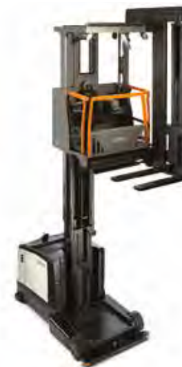
Serie TSP 6500 Trilaterale Portata: 1000, 1250 e 1500 kg Altezza di sollevamento: 4900 a 13485 mm
