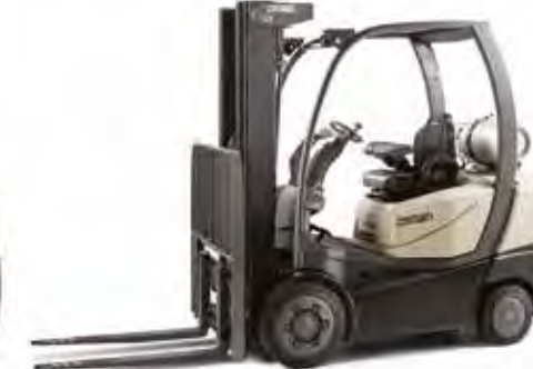
Serie C-5 Carrello controbilanciato a 4 ruote con motore GPL e pneumatici Cushion Portata: 2000, 2500 e 3000 kg Altezza di sollevamento: 2665 a 7465 mm
