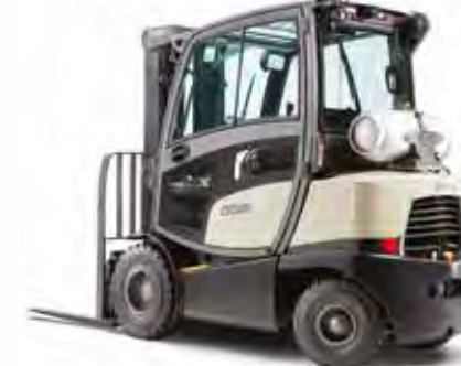
Serie C-5 Carrello controbilanciato a 4 ruote con motore GPL e cabina completa Portata: 2000, 2500 e 3000 kg Altezza di sollevamento: 2665 a 7465 mm
