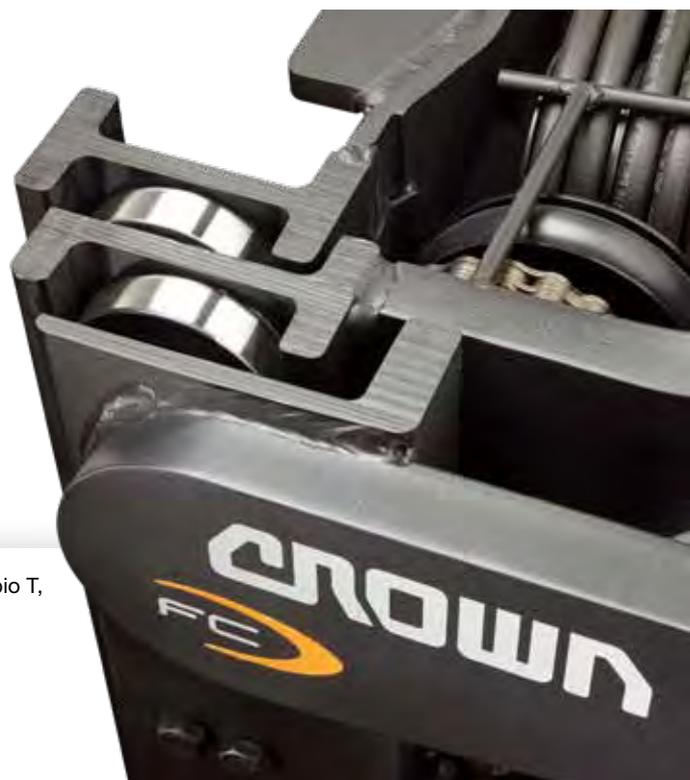
Il **montante rimane stabile** grazie al rigido design dei profili a doppio T, in grado di resistere a piegamenti e torsioni longitudinali e laterali.
