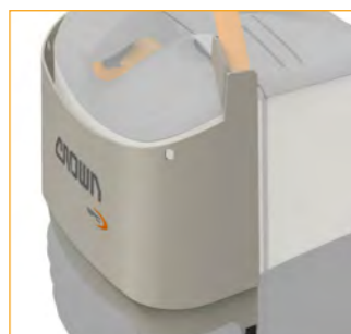
Paraurti supplementare in acciaio resistente spesso 8 mm (GPC 3055)
