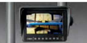
Le telecamere opzionali per forche o montante facilitano la movimentazione e posizionamento del carico.
