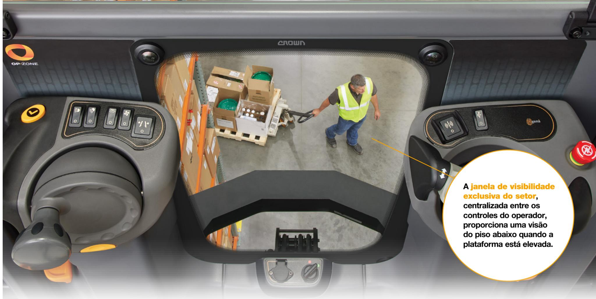
A janela de visibilidade exclusiva do setor, centralizada entre os controles do operador, proporciona uma visão do piso abaixo quando a plataforma está elevada.
