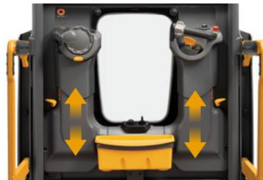
As bases de controle opcionais ajustáveis de forma independente proporcionam flexibilidade e conforto extras para operadores de diversas alturas.
