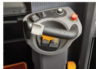
O conjunto de controles direito permite que o operador integre com facilidade as funções da empilhadeira. O botão de navegação do display opcional possibilita uma navegação alternativa na tela.
