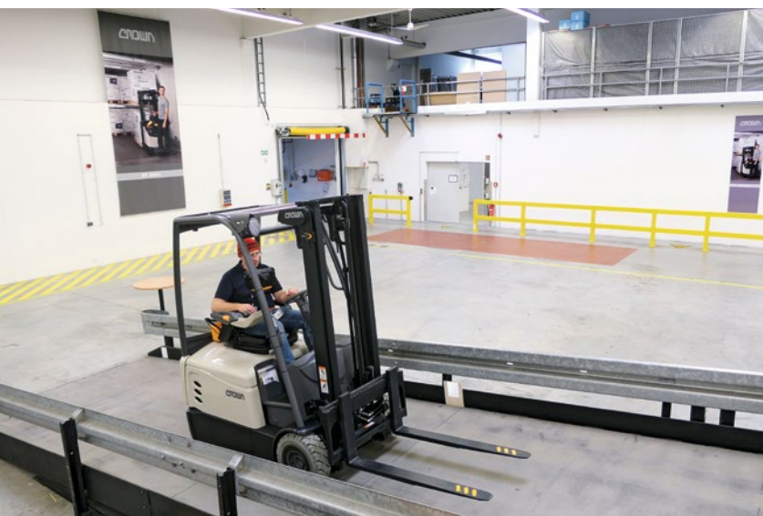
De heftruck overtuigt doordat hij zachtjes de helling op rijdt – zonder terug te rollen
