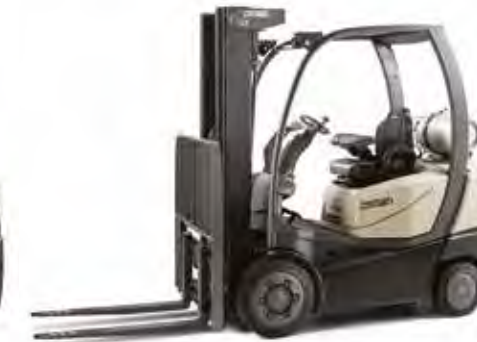
C-5 Serie LPG-vierwieltruck met contragewicht en luchtbanden Hefvermogen: 2000, 2500 en 3000 kg Hefhoogte: 2665 tot 7465 mm
