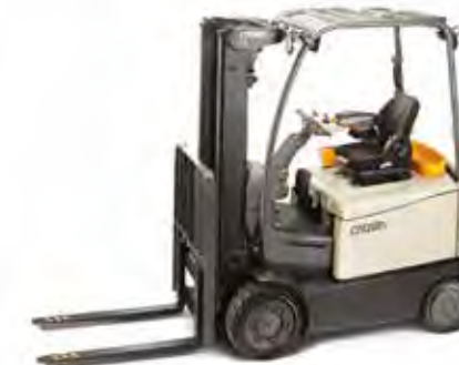
FC 5200 Serie Vierwieltruck met contragewicht Hefvermogen: 2000, 2500 en 3000 kg Hefhoogte: 2895 tot 7925 mm
