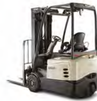
SCT 6000 Serie Driewieltruck met contragewicht Hefvermogen: 1300, 1600, 1800 en 2000 kg Hefhoogte: 2895 tot 7490 mm
