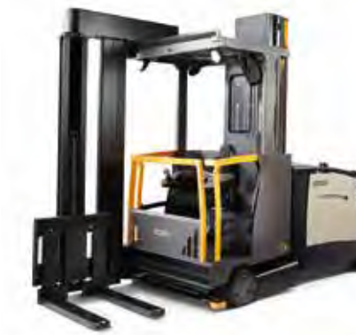
TSP 7000 Serie Hoogstapeltruck Hefvermogen: 1000, 1250 en 1500 kg Hefhoogte: 4900 tot 17145 mm
