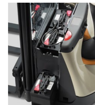
Conjunto de baterias
