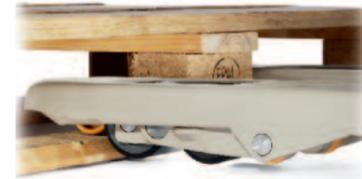
Кронштейны крепления оси вилок грузовых колес, подъемный носок и подкатной ролик сконструированы с расчетом на максимально долговечную работу и ударостойкость. Комбинированный эффект для оператора – свободный вход и выход тележки даже при пустом поддоне. Нижнее положение вилок составляет всего 75 мм, что обеспечивает легкий доступ к поврежденным или тяжело доступным поддонам.
