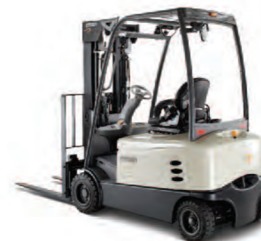
Серия SCF 6000 4-х опорный противовесный погрузчик Грузоподъемность: 1600, 1800 и 2000 кг Высота подъема: от 2890 до 7495 мм
