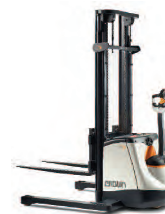
Серия SX 3000 Штабелер с широкой базой Грузоподъемность: 1350 кг Высота подъема: от 2400 до 4250 мм
