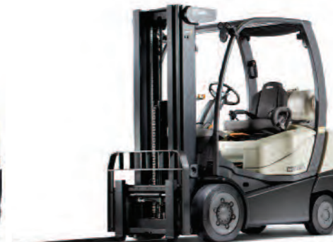
Серия С-5 4-колесный погрузчик с противовесом и полупневматическими шинами, работающий на сжиженном газе Грузоподъемность: 2000 и 3000 кг Высота подъема: от 2920 до 7465 мм
