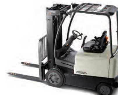
Серия FC 4500 4-х опорный противовесный погрузчик Грузоподъемность: 2000, 2500 и 3000 кг Высота подъема: от 3200 до 7925 мм
