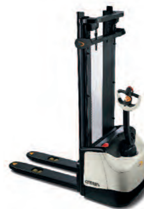
Серия WF 3000 Штабелер для паллет Грузоподъемность: 1000 и 1200 кг Высота подъема: от 1550 до 4400 мм
