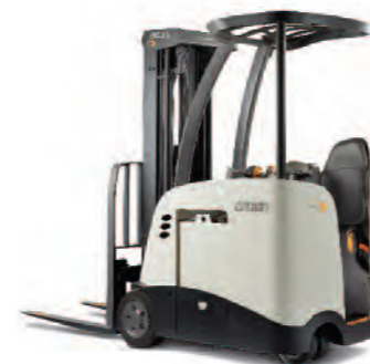
Серия RC 5500 3-х опорный стоячий противовесный погрузчик Грузоподъемность: 1500 и 1800 кг Высота подъема: от 3910 до 7010 мм
