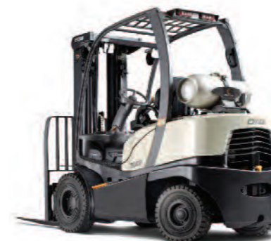
Серия С-5 4-колесный погрузчик с противовесом и сверхэластичными шинами, работающий на сжиженном газе Грузоподъемность: 2000 и 3000 кг Высота подъема: от 2920 до 7465 мм
